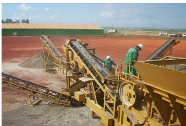
Vista parcial do sistema britador de RCC.
