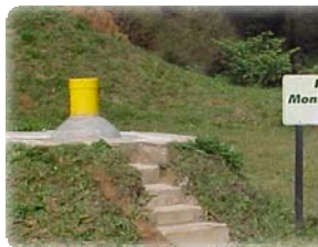
Poço de monitoramento de águas subterrâneas instalado no CGR-Itapevi.
