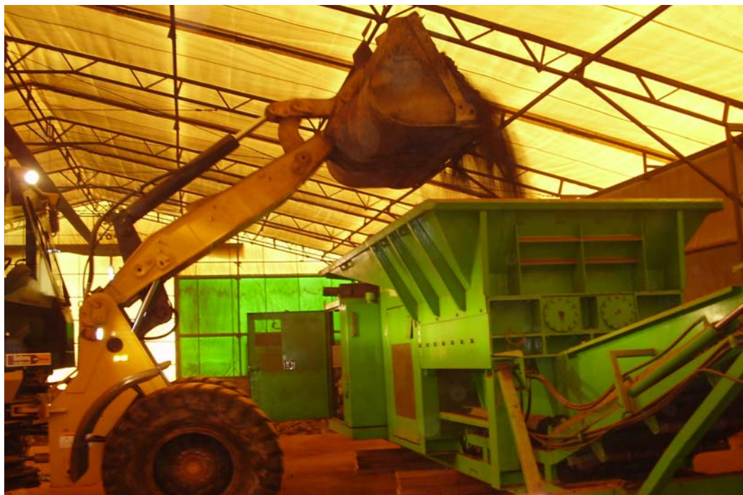
Interior de galpão da Unidade de Biorremediação do CGR-Paulínia: Detalhe do descarregamento de solo no equipamento homogeneizador utilizado no processo de tratamento.
