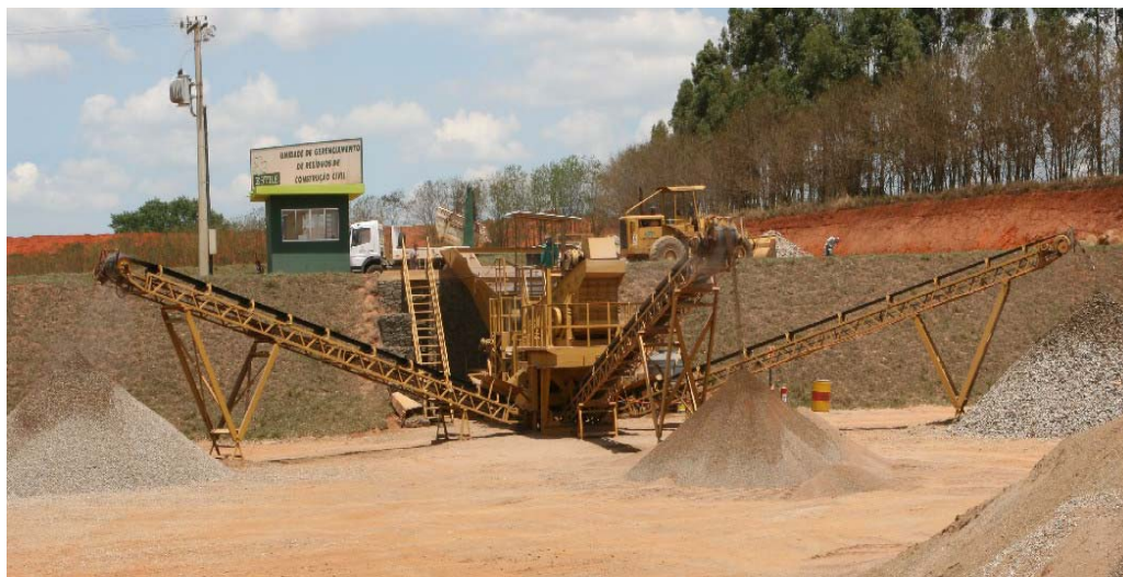
Vista geral do sistema britador de resíduos da construção civil (RCC).
